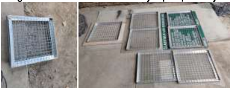
Imagen 8. Elaboración de marco y tapas para cajas de aguas residuales
